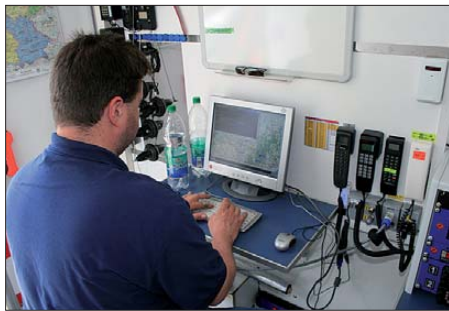
DG1FDV beim Konfigurieren des APRS-Empfangs am 2. Arbeitsplatz der mobilen Funkeinheit; rechts: Mobiltelefon (D-Netz), die Handapparate der 2-m- und 70-cm-Geräte
