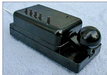
Bild 3: Platz sparende Unterbringung des Morsegebers in einer Morsetaste
