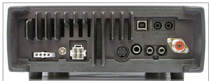
Bild 3: Rückansicht des IC-7200. Auffallend sind die seitlichen Puffer, die ein hochkantiges Abstellen gefahrlos möglich machen; links der Luftauslass
