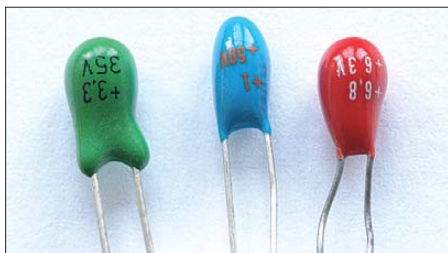
Bild 55: Typische Tropfenbauform von Tantal-elektrolytkondensatoren
