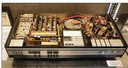
Zur Funkausstellung 1971 kam dann das „VCR“-Kassettsystem mit besserer Bildqualität und ohne das Einfädelproblem der Spulen-Videorecorder. Die in den VCR-Kassetten übereinander statt nebeneinander liegenden Spulen sorgten allerdings oft für Bandklemmer.
