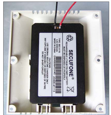
Bild 10: Der flache Akkumulator kann auch im Gerät angebracht werden.
