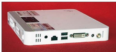
Bild 3: Auf der Rückseite liegen unter anderem Anschlussmöglichkeiten für den Monitor und das Netzkabel.
