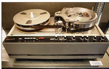
Semiprofessioneller Videorecorder „BK 300“ mit 1-Zoll-Band und übereinander liegenden Spulen von 1965. Die besonders große Kopftrommel (größer als die Bandspulen!) sorgte für eine besonders hohe Videoauflösung; benutzt wurden derartige Geräte bis in die 1980er-Jahre in der Medizin an Röntgengeräten.
