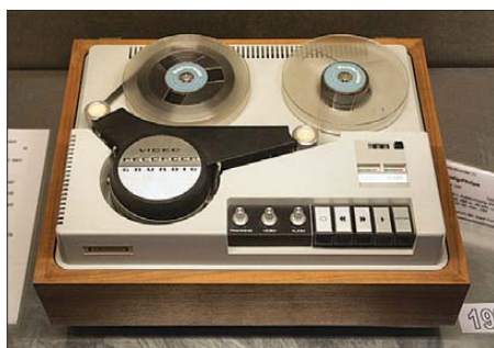
Erster Heimvideorecorder (s/w) von Grundig (und Philips) von 1970. Nutzte 1/2-Zoll-Band mit verkleinerter Trommel und damit auch deutlich eingeschränkter Bildqualität. Das Einfädeln des Bands war ziemlich knifflig.
