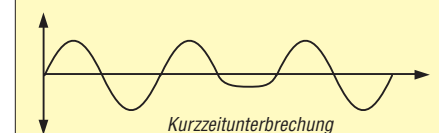
Bild 4: Eine Kurzzeitunterbrechung ist das Ausbleiben einer oder mehrerer Halbwellen oder ihre starke Verminderung.
