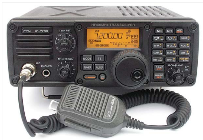
Bild 1: Frontansicht des IC-7200. Unverkennbar seine gestalterische Ähnlichkeit mit kommerziellen Geräten für den ortsveränderlichen Einsatz. Oben rechts vorn befindet sich der Lufterlass für die Endstufe, darunter liegen schräg die beiden Lüfter; der hintere Teil der oberen Plastik-Gehäuseschale ist zur Luftführung geschlossen.
